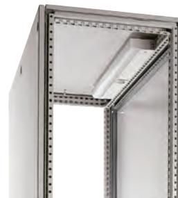
**Описание:** Лампа дневного света с выключателем, электрическим стартером, со встроенным разъемом и защитным козырьком. Штекер типа "вилка" для подключения питания с одной стороны, разъем типа "розетка", позволяющий подключать к питанию другое оборудование, с другой стороны. Дополнительный соединитель ST 17/2 позволяет активировать лампу с помощью дверного выключателя.
