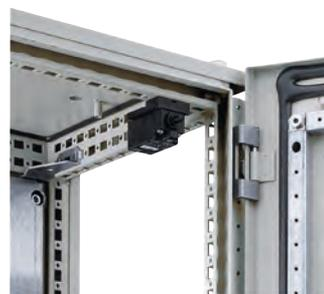
**Описание:** Активирует любое электрическое устройство (внутреннее освещение, устройства климатизации и т.д.). Крепится после установки монтажной панели, т.к. в противном случае он будет препятствовать установке. Крепится без использования винтов к внутренним отверстиям шкафной рамы. Ввод кабеля М 20.
