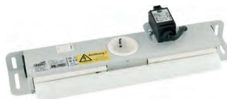
**Описание:** Светильник для шкафа со встроенным дверным выключателем. Штекерное соединение типа "вилка" (VDE0625/EN60230) вмонтировано для облегчения установки. Установлен разъем "Schuko" с защитным контактом и выключатель, также имеется возможность сквозной проводки питания. Легко устанавливается на 25 мм разметку отверстий.
