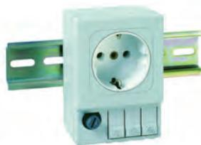
**Описание:** Электрическая розетка для установки на DIN-рейку. Пружинные зажимы для быстрого и простого подключения провода. Подключение: 3 пружинных зажима для скрученного жесткого провода 0,5 - 2,5 мм<sup>2</sup>. Встроенный предохранитель 6,3 А 5x20 мм.
